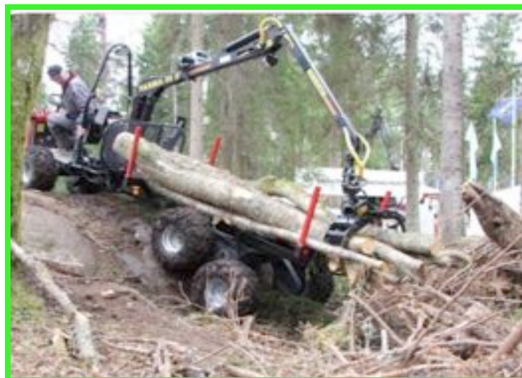
Mini esboscatore Alstor 8x8 portata 20 Qli
