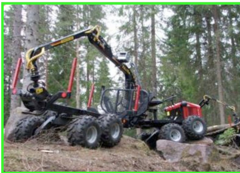
Mini esboscatore Alstor 8x8 portata 20 Qli
